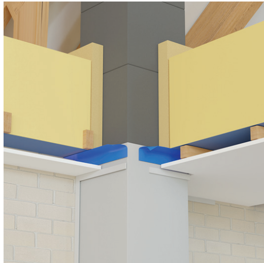
Periaatekuva kivirakenteisen savupiipun yläpohjan läpiviennistä; Schiedel.
